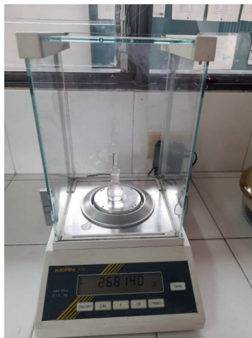
Figura 34 Pesaje del picnómetro lleno en la balanza.
